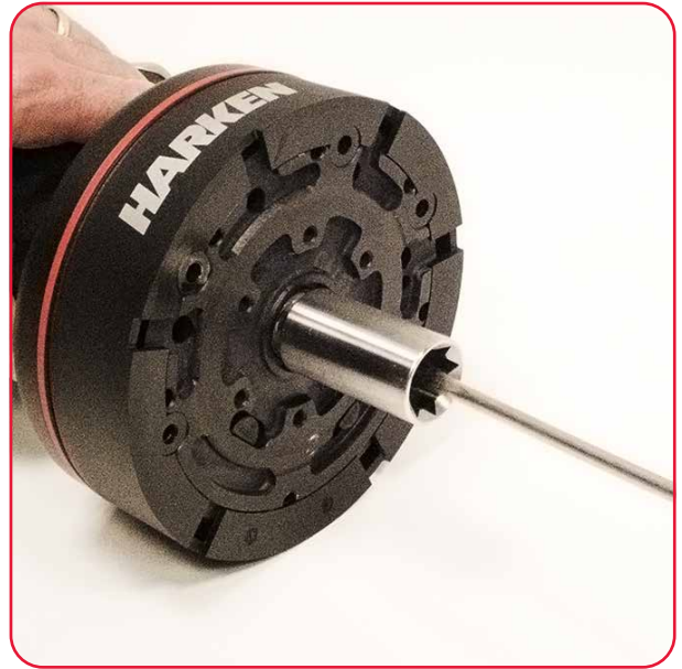
5. Bloquer la vis sur l'accouplement de la manivelle.
