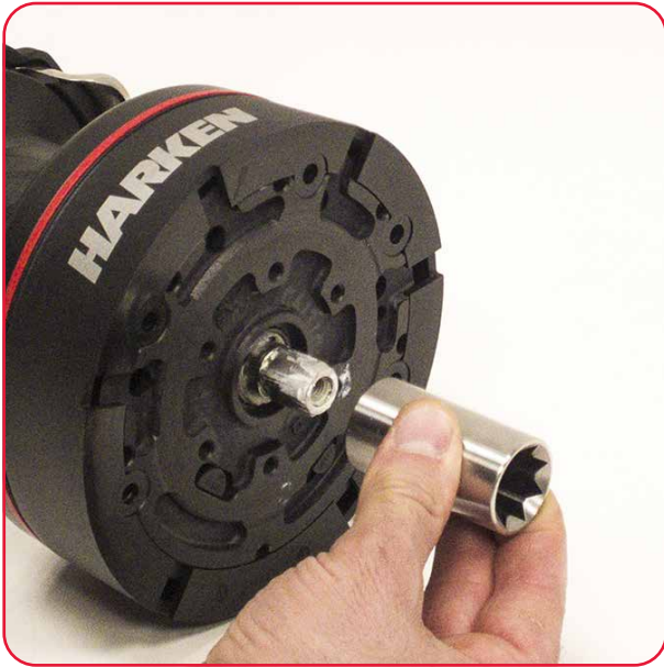
4. Positionner l'accouplement de la manivelle sur l'arbre.
