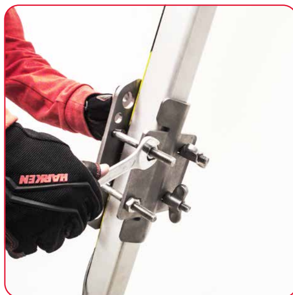
2. Serrer les deux écrous avec une clé (30 Nm)
