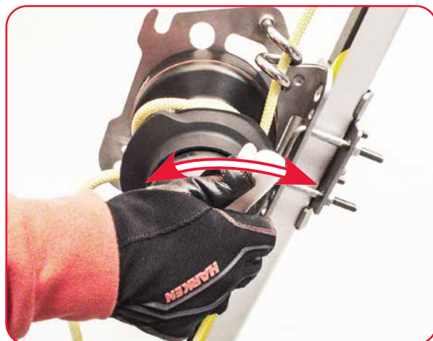
Contrôler le bon fonctionnement du levier de commande de la demi-poulie en le tournant et en le relâchant.
