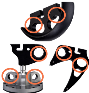
Fig. 13 : Points de fixation de la sangle d'entrave à came
