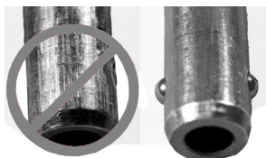
Fig. 31 : Goupille de gauche : retirée en raison de l'usure et du mauvais fonctionnement de sa douille de détente ; Goupille de droite : en bon état de fonctionnement
