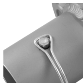
Fig. 2 Goupille d'accouplage de la jambe correctement sécurisée
