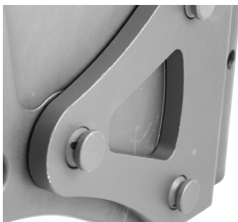
Fig. 6 Goupilles entièrement insérées dépassant correctement du clameau de jambe
