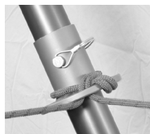
Fig. 24 Bague d'arrimage utilisé près de la section de pied pour une meilleure stabilité
