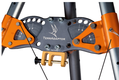
Fig. 7 Clameaux de jambe de compensation (gauche vers l'avant, droite vers l'arrière) à des fins d'illustration. Selon les meilleures pratiques, les deux clameaux de jambe décalés sont orientés vers l'avant dans une configuration de trépied typique
