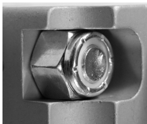
Fig. 21 Le boulon affleure légèrement
