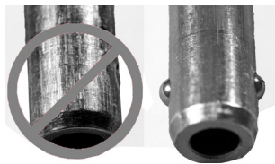
Fig. 18 Goupille gauche – retirée en raison de l'usure et du fonctionnement incorrect des chevilles d'arrêt; goupille droite – en bon état de fonctionnement
